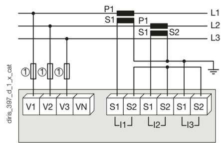
Der Einsatz von 2 SW mindert die Phasengenauigkeit um 0,5%. Der Strom wird per Vektorberechnung abgeleitet.
