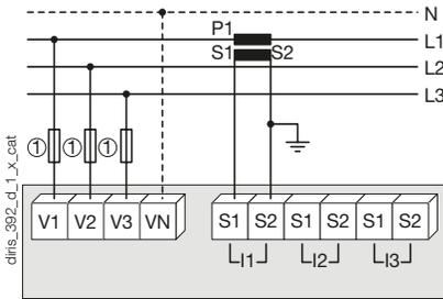
Der Einsatz von 1 SW mindert die Phasengenauigkeit um 0,5%. Der Strom wird per Vektorberechnung abgeleitet.
