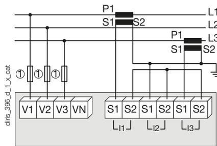
Der Einsatz von 2 SW mindert die Phasengenauigkeit um 0,5%. Der Strom wird per Vektorberechnung abgeleitet.
