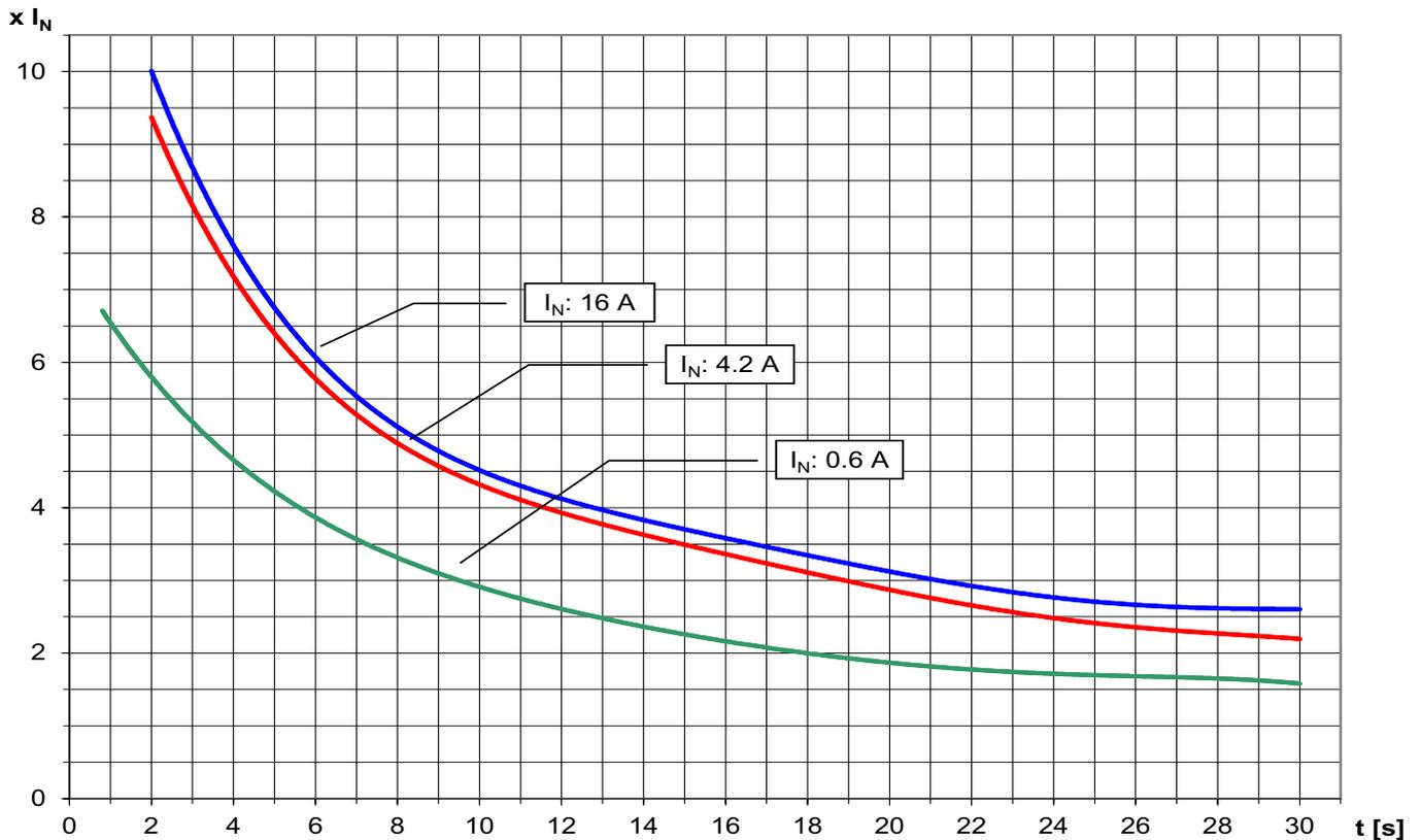
Unsere Rohrwiderstände Typ FW können kurzzeitig sehr stark überlastet werden. Dieses Überlastverhalten zeigen die oben stehenden Kurven. Der Belastungsfaktor in Funktion der Belastungszeit ist für drei verschiedene Nennströme  $I_N$  aufgezeigt. Zwischenwerte der Nennströme können inter- bzw. extrapoliert werden. Die Kurven gelten als Richtwerte ohne hohe Genauigkeit.
