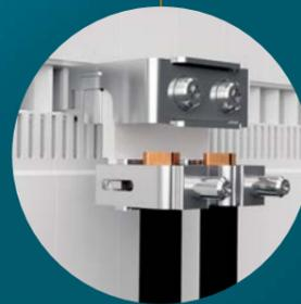
**Leiteranschlussklemme** für Kupfer und Aluminium. Diese ist für 2 Rundleiter bis 300 mm<sup>2</sup> geeignet.
