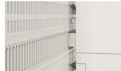
I componenti si innestano agevolmente sul CrossBoard®, senza l'utilizzo di attrezzi. L'aggancio meccanico ed il collegamento elettrico avvengono nello stesso momento, in un'unica operazione. La protezione contro l'inversione di polarità esclude qualsiasi errore di montaggio.
