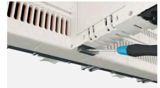
I componenti possono anche facilmente essere disinstallati, per essere montati in un'altra posizione sul CrossBoard®. Per lo smontaggio, per motivi di sicurezza, è necessario sbloccare preventivamente il meccanismo di arresto con un cacciavite. In questo modo un componente non potrà mai essere tolto per errore.
