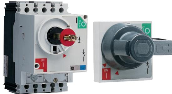
Ein Frontdrehantrieb und eine Blende werden in die Tür bzw. die Abdeckung installiert. Der Hebel wird über eine Verlängerungswelle mit einem direkt auf die Vorderseite des Leistungsschalters montierten Adapter verbunden. Diese Konstruktion kann eine Gesamttiefe von bis zu 350 mm überbrücken (Rückseite Schalter bis Vorderseite Tür bzw. Abdeckung).
