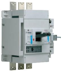
Die Ausfahrtechnik wird als komplette Baugruppeneinheit geliefert, mit einem beweglichen und einem festen Teil sowie Anbauteilen zum Umbau des Standard Leistungsschalters. Die Ausfahrtechnik enthält eine Handkurbel zum Ein- und Ausfahren des Leistungsschalters und kann ohne weitere Zubehörteile hinter geschlossener Schaltschranktür oder für eine
