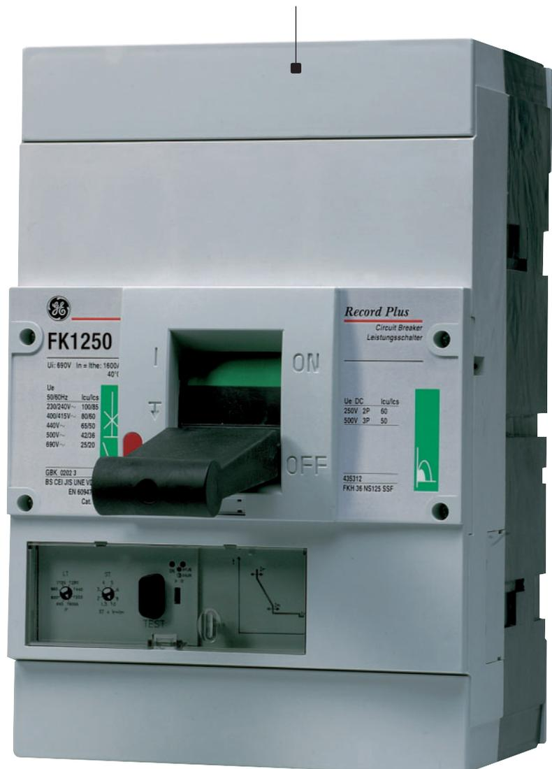
Die **Record Plus™** Leistungsschalter sind für den Schutz, die Trennung und das Schalten von Stromkreisen in Niederspannungsverteilungen vorgesehen. Der Schutz der Stromkreise wird durch eine Kombination aus den jeweiligen Strombegrenzungseigenschaften der Geräte und integrierten Schutzeinrichtungen, im Allgemeinen als Auslöser bezeichnet, realisiert.
