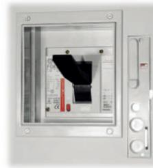
Mit dem Adaptersatz Typ F-WT wird die Leistungsschalterausführung mit Kipphebel zusammen mit dem Bedien- und Anzeigefeld montiert. Der Anbausatz enthält einen verlängerten Kipphebel, Ausfahrblende, Türausschnittsrahmen und das Bedien- und Anzeigefeld mit allen Anzeige- und Verriegelungsmöglichkeiten.
