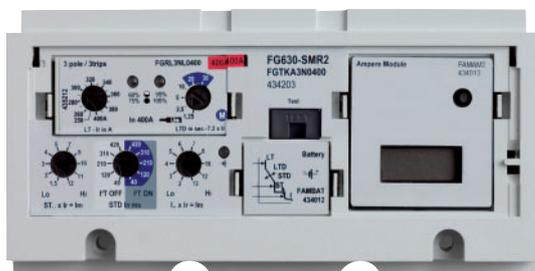
Diese einfach zu bedienende Auslöseeinheit verfügt über ein LT-Lastanzeigergerät mit zwei LED-Anzeigen an der Vorderseite der Auslöseeinheit. Wenn die Last 60% des für Ir eingestellten Wertes erreicht, beginnt eine **grüne LED** zu blinken. Erreicht die Last 75% von Ir, leuchtet diese LED dauerhaft. Die zweite **orangefarbene LED** beginnt bei 95% des Wertes Ir zu blinken. Bei Erreichen von 105% von Ir leuchtet diese LED dauerhaft und eine Auslösung steht unmittelbar bevor.
