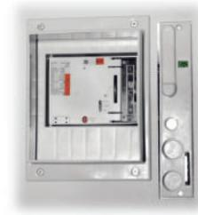
Mit dem Adaptersatz Typ F-WM wird die Leistungsschalterausführung mit elektrischen Antrieb zusammen mit dem Bedien- und Anzeigefeld montiert. Der Anbausatz enthält eine Ausfahrblende, Türausschnittsrahmen und das Bedien- und Anzeigefeld mit allen Anzeige- und Verriegelungsmöglichkeiten.
