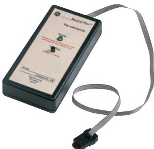
Das Testgerät ermöglicht die Überprüfung der mechanischen und elektrischen Funktion des Auslösers in Kombination mit der Auslöse- spule. Der Stecker wird einfach in die Testbuchse am Auslöser gesteckt und über einen Taster am Testgerät wird dann
