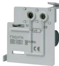
Wenn sich der Leistungsschalter in der Position EIN befindet und der Arbeitsstromauslöser aktiviert wird, wird der Leistungsschalter ausgelöst und seine Kontakte werden geöffnet. Das Gerät kann bei seiner Nennspannung permanent aktiviert sein und kann dadurch als Verriegelungsspule verwendet werden. Die Anschlussklemmen sind mit C1 und C2 gekennzeichnet.
