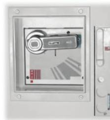
Mit dem Adaptersatz Typ F-WN wird die Leistungsschalterausführung mit Drehantrieb zusammen mit dem Bedien- und Anzeigefeld montiert. Der Anbausatz enthält eine Ausfahrblende, Türausschnittsrahmen und das Bedien- und Anzeigefeld mit allen Anzeige- und Verriegelungsmöglichkeiten.
