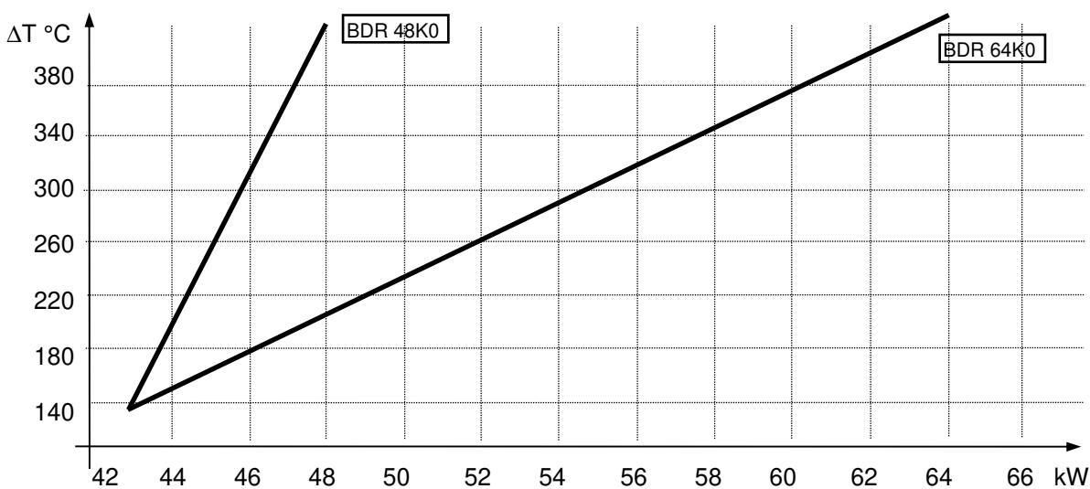
E' la temperatura della superficie della custodia nella parte superiore, misurata con termocoppia durante un impiego continuativo alla potenza nominale, con una temperatura ambiente di 25°C.
