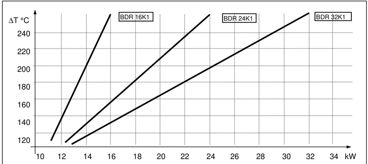
E' la temperatura della superficie della custodia nella parte superiore, tetto, misurata con termocoppia a contatto durante un impiego continuativo alla potenza nominale, con una temperatura ambiente di 25°C.
