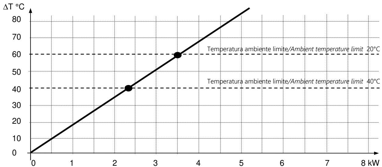
I limiti fissati dalle linee tratteggiate indicano le potenze massime applicabili per evitare che la temperatura della custodia ecceda gli 80°C. Al di sopra di questa temperatura le normative vigenti impongono la segnalazione di alta temperatura per segnalare il rischio di ustione in caso di contatti accidentali.
