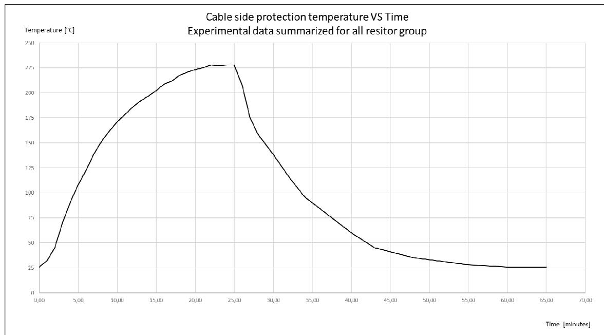
E' la temperatura della superficie della custodia nella parte superiore, misurata con termocoppia durante un impiego continuativo alla potenza nominale, con una temperatura ambiente di 25°C.
