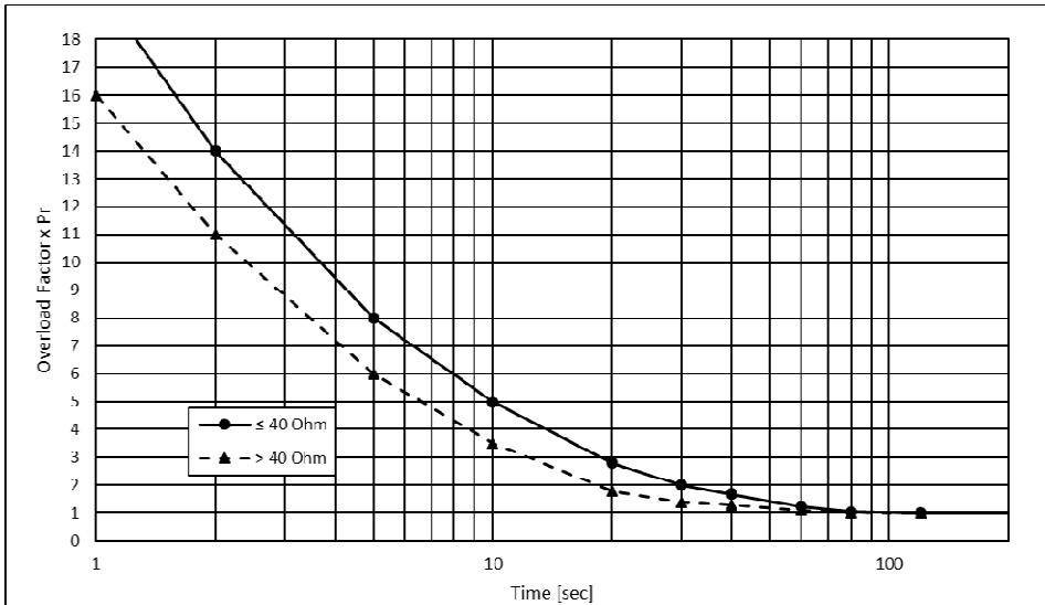
La curva mostra la capacità di sovraccarico con fattori moltiplicativi della potenza nominale per carichi impulsivi di data durata con un tempo di ciclo di 120 secondi. Per valori Ohmici elevati riferirsi alla nota seguente.
