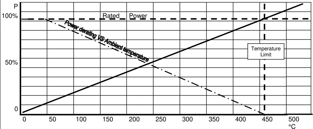
Questi diagrammi sperimentali danno indicazioni sulla riduzione percentuale di potenza in funzione della temperatura ambiente di lavoro. La Potenza nominale continuativa,  $P_R$ , è stata misurata in condizioni di laboratorio con resistore montato in aria.
