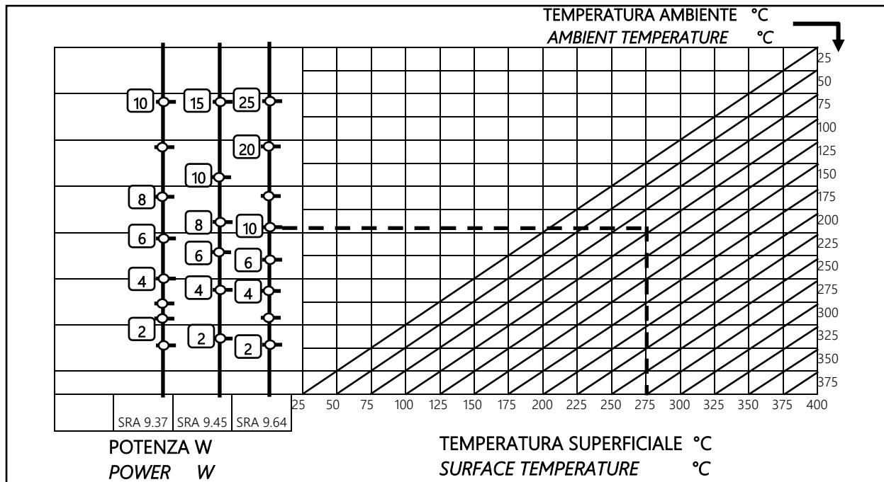
Questo diagramma sperimentale fornisce importanti indicazioni sulla massima potenza dissipabile e sulla temperatura superficiale di un resistore SRA in diverse condizioni di carico.
